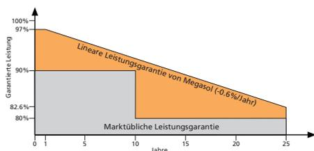
Relativer Wirkungsgrad in Bezug zur Minimalleistung (%). Mind. 97% der Minimalleistung innerhalb des ersten Jahres. Danach max. 0.6% Degradation pro Jahr. Mind. 91.6% der Minimalleistung nach 10 Jahren. Mind. 82.6% der Minimalleistung nach 25 Jahren. Alle Daten innerhalb der Messtoleranzen. Garantien gemäss den Megasol-Garantiebedingungen jeweils neuester Fassung, welche unter [www.megasol.ch/garantie](http://www.megasol.ch/garantie) zur Verfügung stehen.
